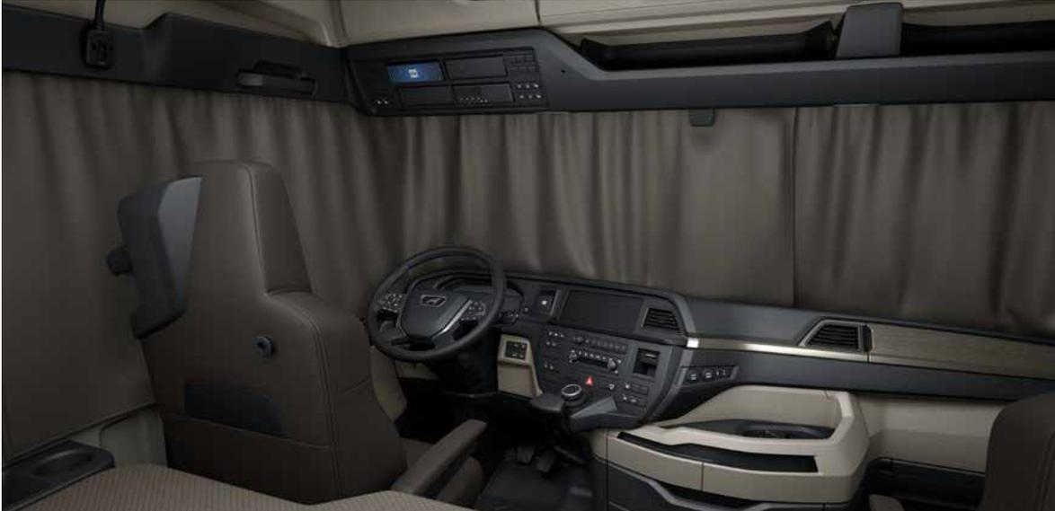
Der blickdichte Rundumvorhang sichert die Privatsphäre während der Ruhezeiten und ermöglicht erholsame Schlafpausen – durch die Verdunkelung auch am Tage. Zudem bietet er eine gute zusätzliche Wärmedämmung. Durch die Zweiteilung können auch nur Teile der Front- oder Seitenscheiben verdeckt werden. Der Vorhang kann zum Waschen und Reinigen einfach entfernt werden.
