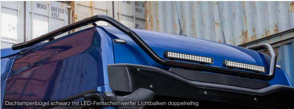
Dachlampenbügel schwarz mit LED-Fernscheinwerfer Lichtbalken doppelreihig
