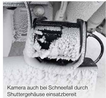
Kamera auch bei Schneefall durch Shuttergehäuse einsatzbereit
