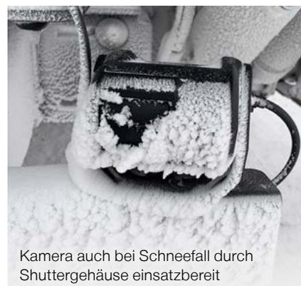
Kamera auch bei Schneefall durch Shuttergehäuse einsatzbereit
